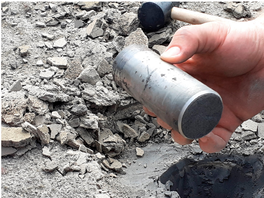
Rys. 5. Pobór próbki o nienaruszonej strukturze z kwatery nr 3 mokrego składowiska odpadów paleniskowych „Jelnia” (sierpień 2022 r.).
