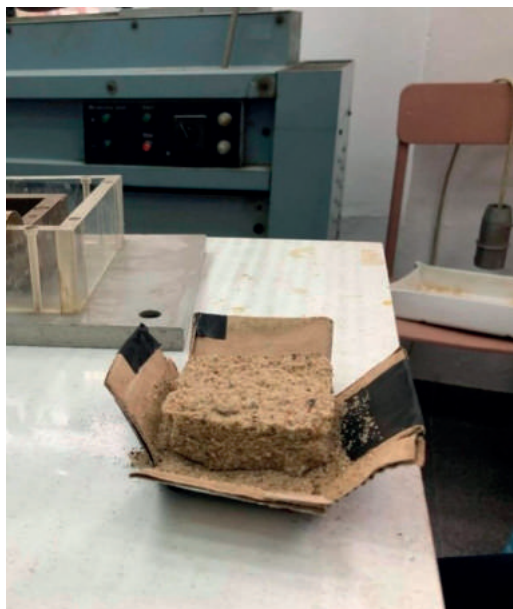
Rys. 7. Próbką zbiocementowanego gruntu
