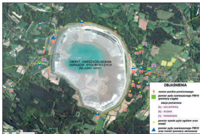
Rys. 1. Lokalizacja punktów pomiarowych monitoringu powietrza atmosferycznego w rejonie OUOW „Żelazny Most” [Ochman, Jezierski 2019]
